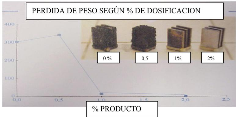
PERDIDA DE PESO DE CHAPAS DE ACERO SUMERGIDAS DURANTE 360 HORAS EN AGUA CON AIREACION CONSTANTE DE 14 lit/min EN SOLUCIONES A DISTINTO PORCENTAJE DE AGENTE INHIBIDOR DE CORROSION
